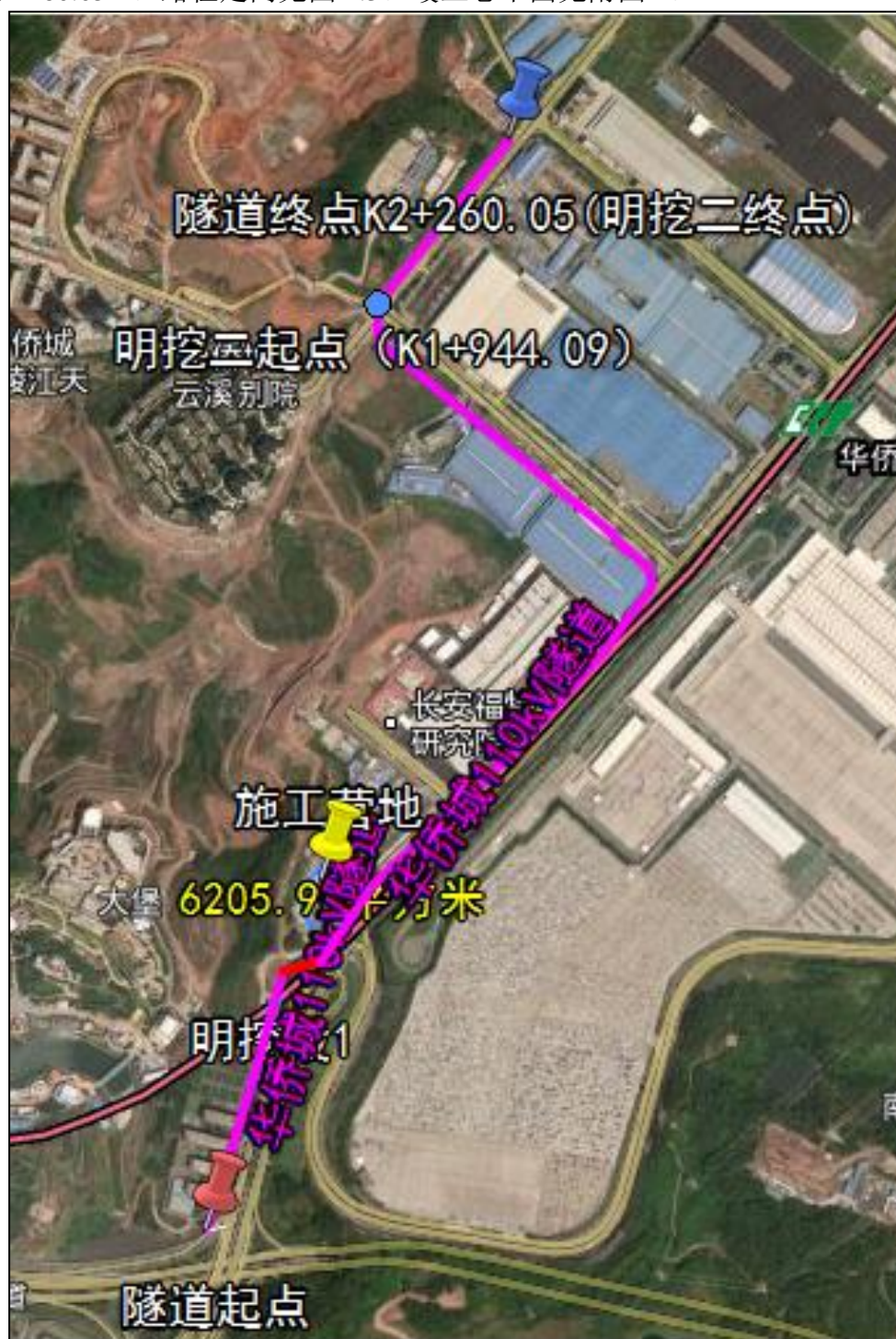
图 2.3 电缆隧道 110kV 路径走向
